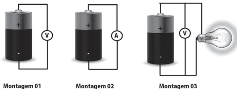
Em um ensaio de laboratório, três montagens, em momentos distintos, com uma mesma pilha gerador real foram realizadas. Os medidores podem ser considerados ideais. Na montagem 01, a leitura do medidor foi de 3,0V; na 02 6A; e, na montagem 03, de 2,5V.
