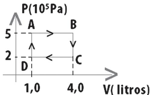
Uma máquina térmica, do tipo motor térmico, opera em ciclos. A cada  $2,0$  segundos, o ciclo apresentado no diagrama de Clapeyron, em destaque, é realizado. A potência útil de tal máquina pode ser calculada, medindo a rapidez com que o dispositivo realiza trabalho.
